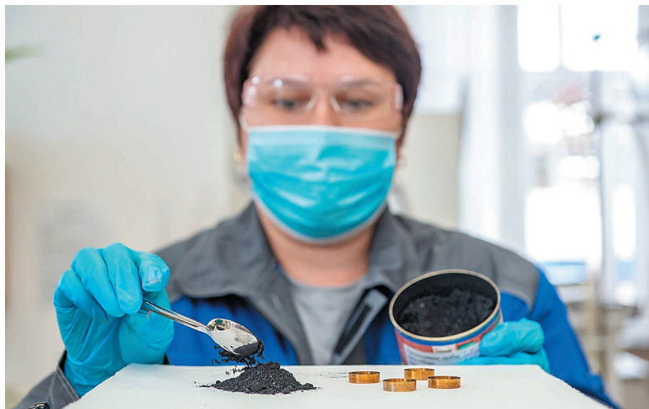
Лаборант НТЦ Мария Герасимова осуществляет подготовку образца пека к определению температуры размягчения по К и С (метод «кольцо и стержень»)
