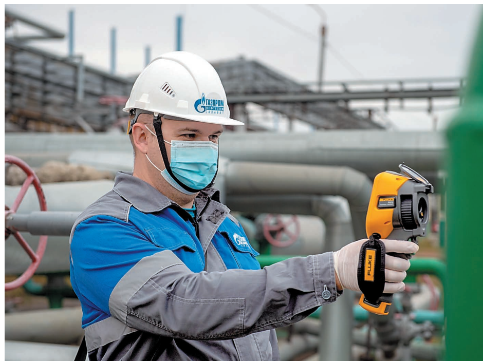
Сотрудники лаборатории проводят замеры температуры греющего пара и конденсата
