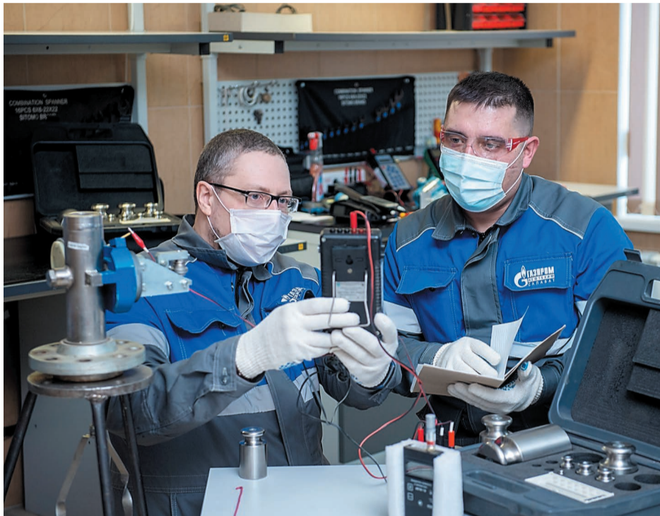
Максим Пантелькин и Виталий Родионов настраивают буйковый уровнемер
