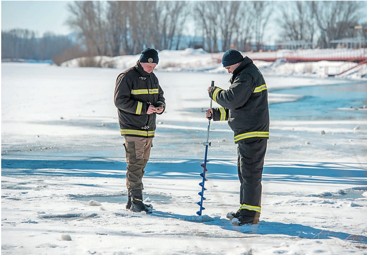
Трижды в сутки спасательные службы замеряют толщину льда на Белой, чтобы следить за таянием льда в динамике, выявлять опасные участки, а также места возможных ледяных заторов
