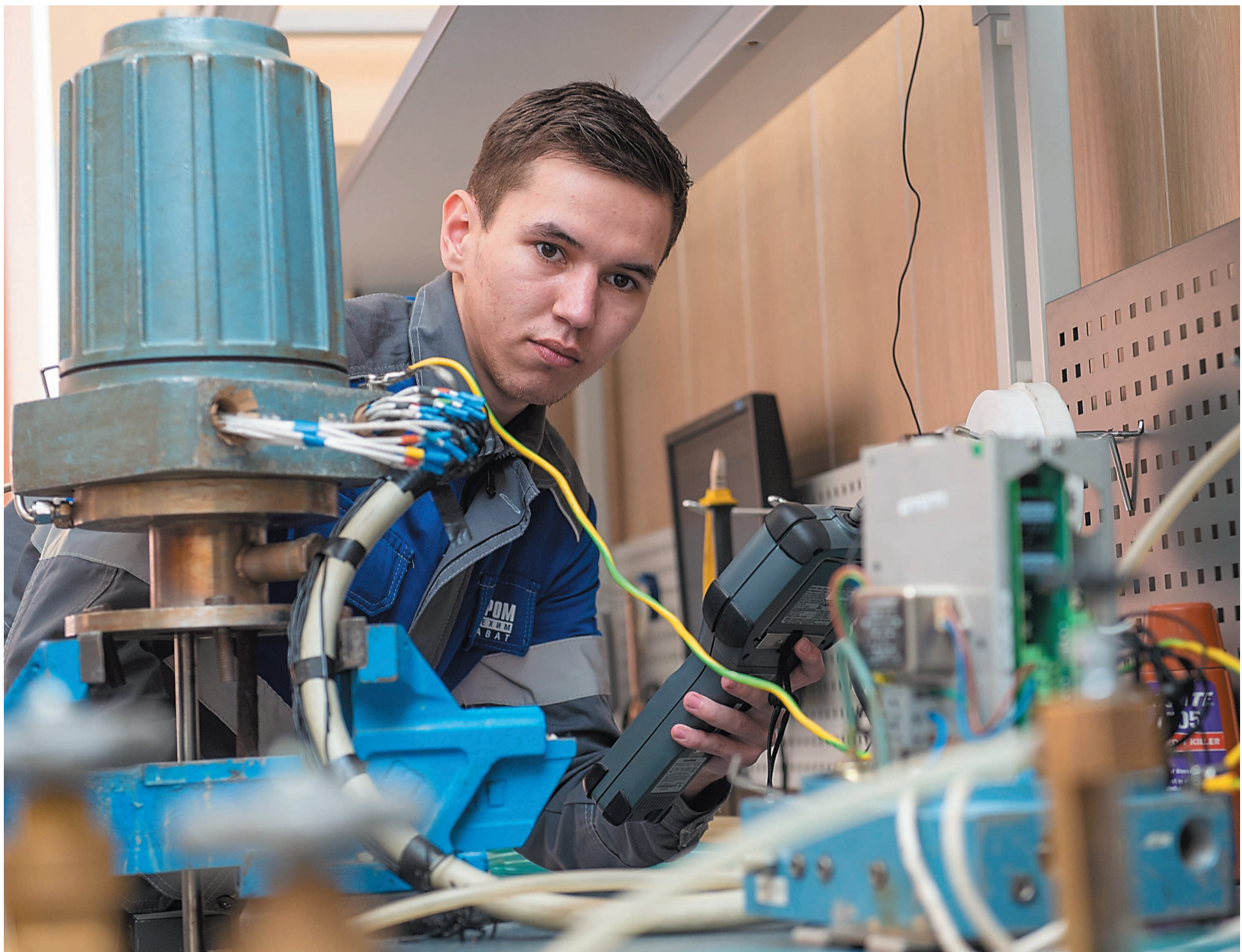
Слесарь по КИП и А Артур Багаутдинов настраивает параметры газоанализатора
