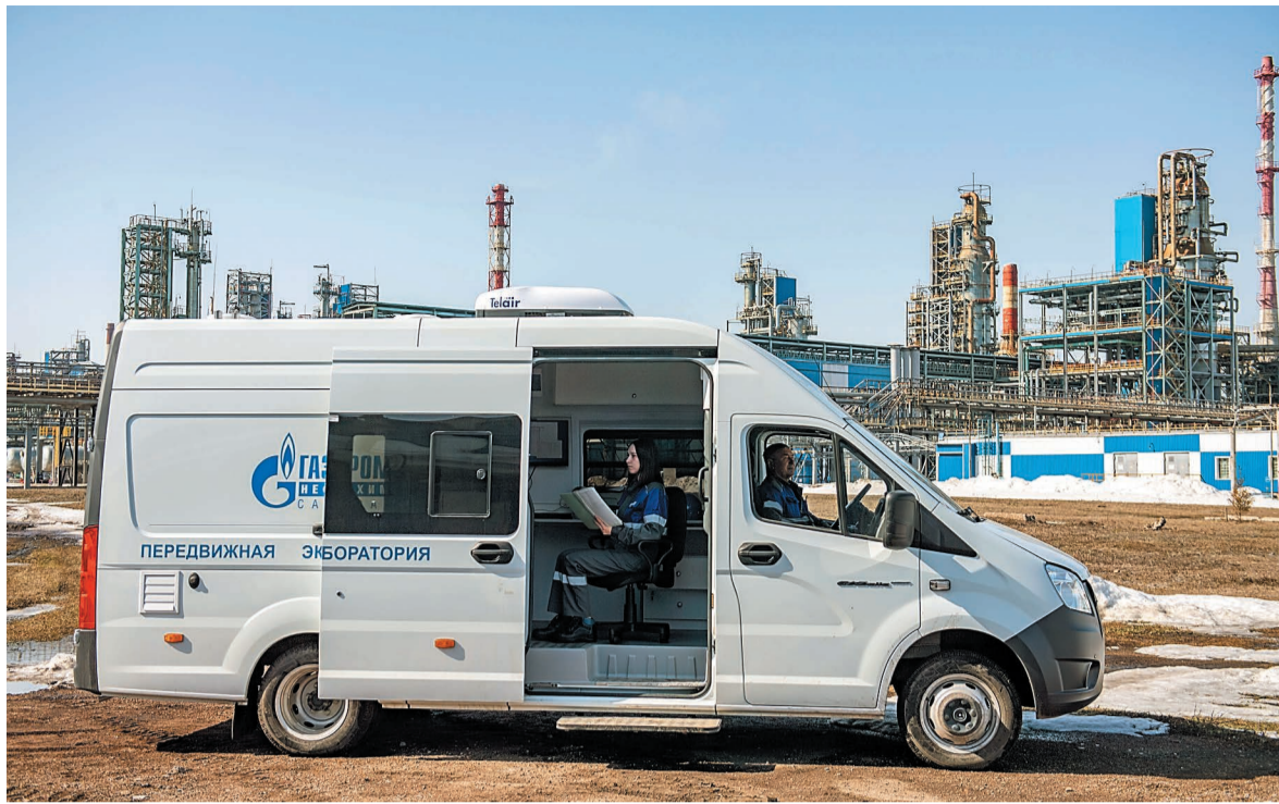
Передвижная экологическая лаборатория на базе автомобиля «Газель Next»
